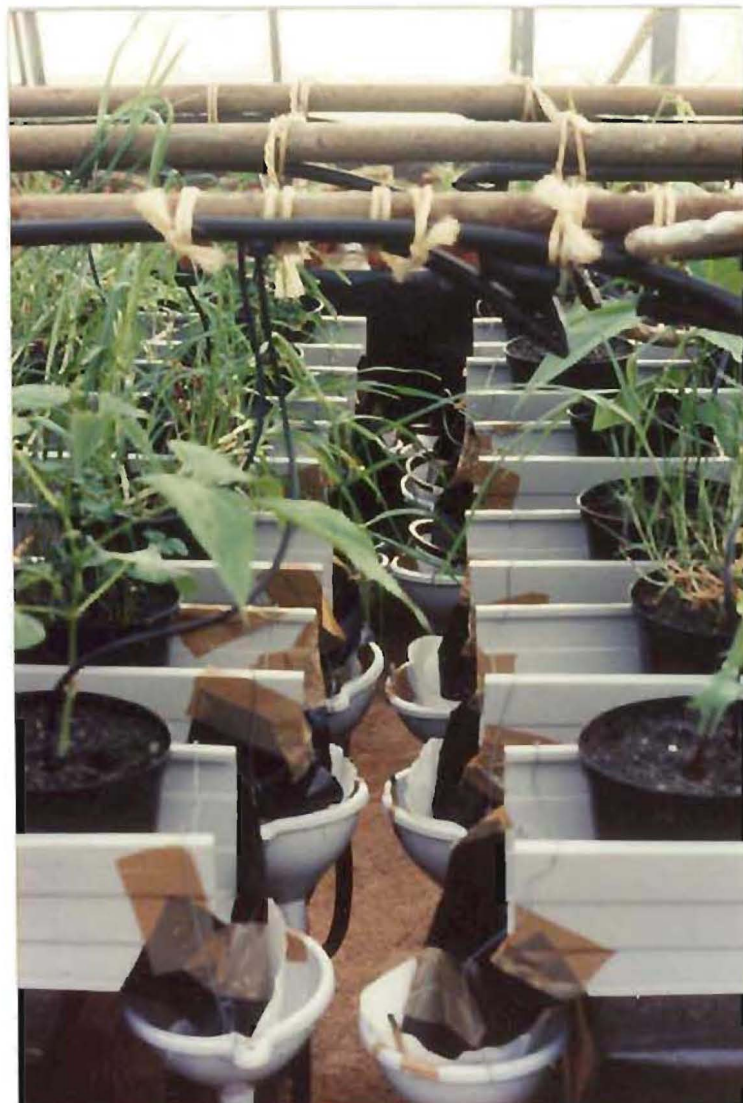
Test de croissance en circuit fermé : dispositif de récupération des filtrats
