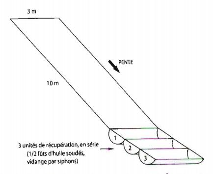
récupérer les eaux de ruissellement et dépôts solides pour analyses
