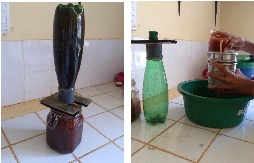
Cliché 2 : Elutriation de sol et récupération des nématodes
