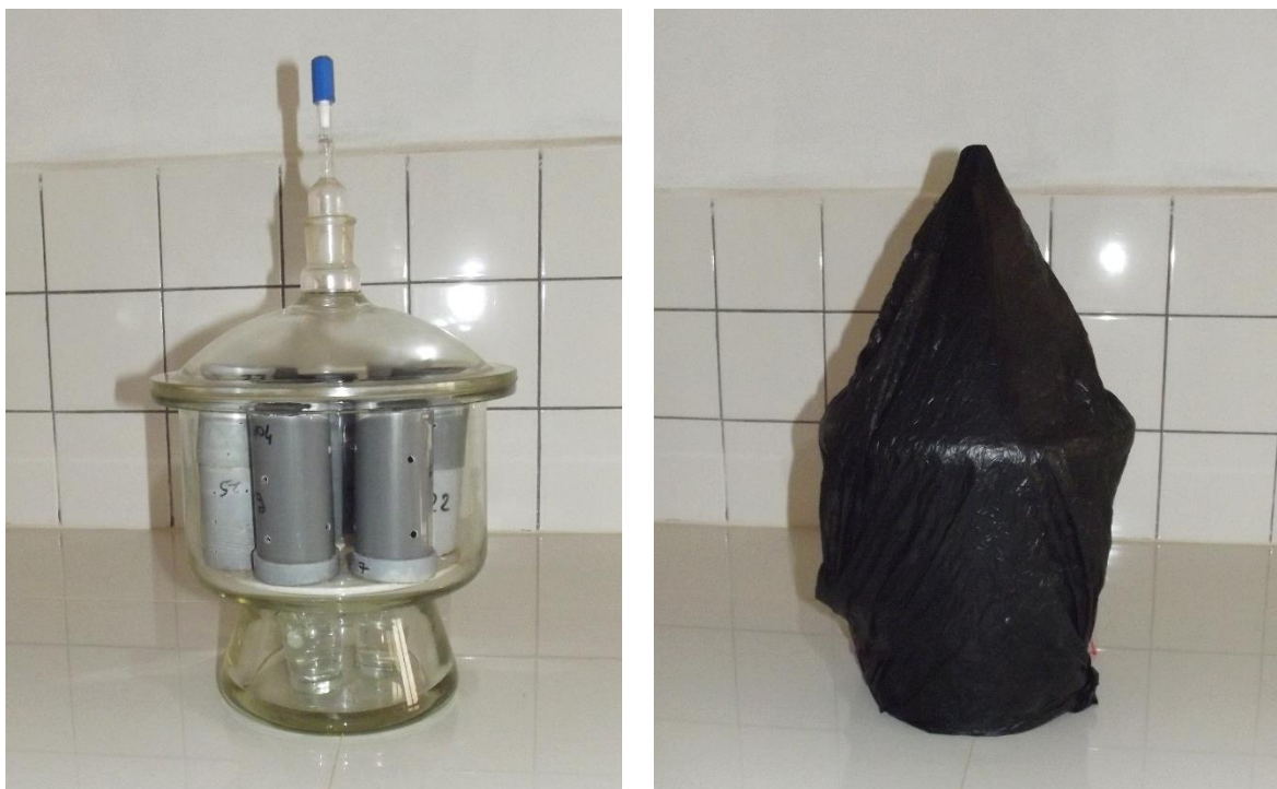
Cliché 4: Fumigation des carottes de sol
