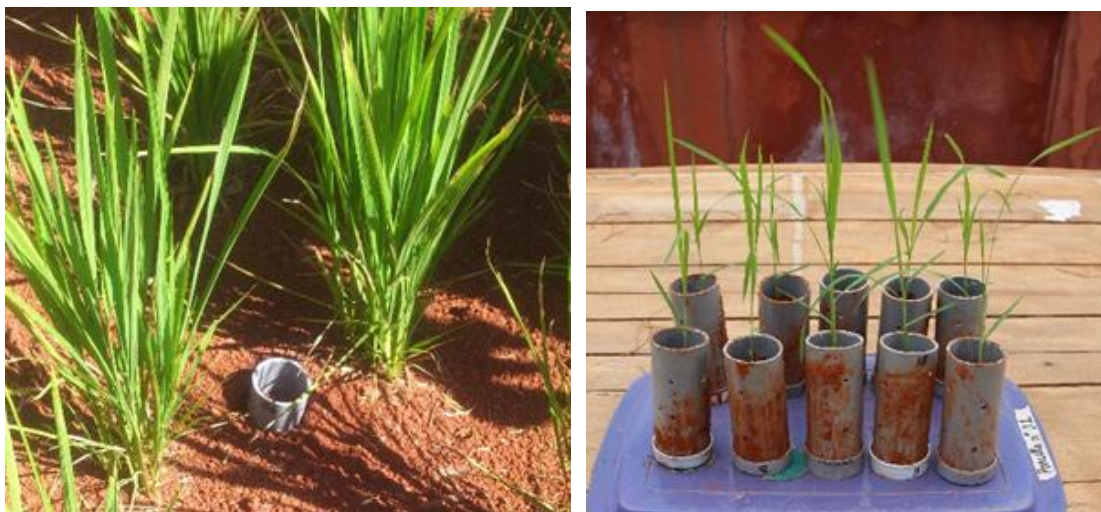
Cliché 3: Echantillonnage de carottes de sol
