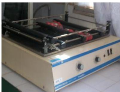
Figure 41 : Agitateur va-et-vient
