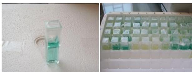
Figure 49 : Cuve jetable pour la lecture au vert de malachite
