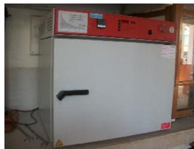
Figure 39 : Etuve pour la détermination de l'humidité
