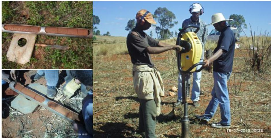
**Figure 13: Prélèvement des sols au carottier**
