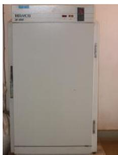
Figure 40 : Etuve pour séchage des matériels
