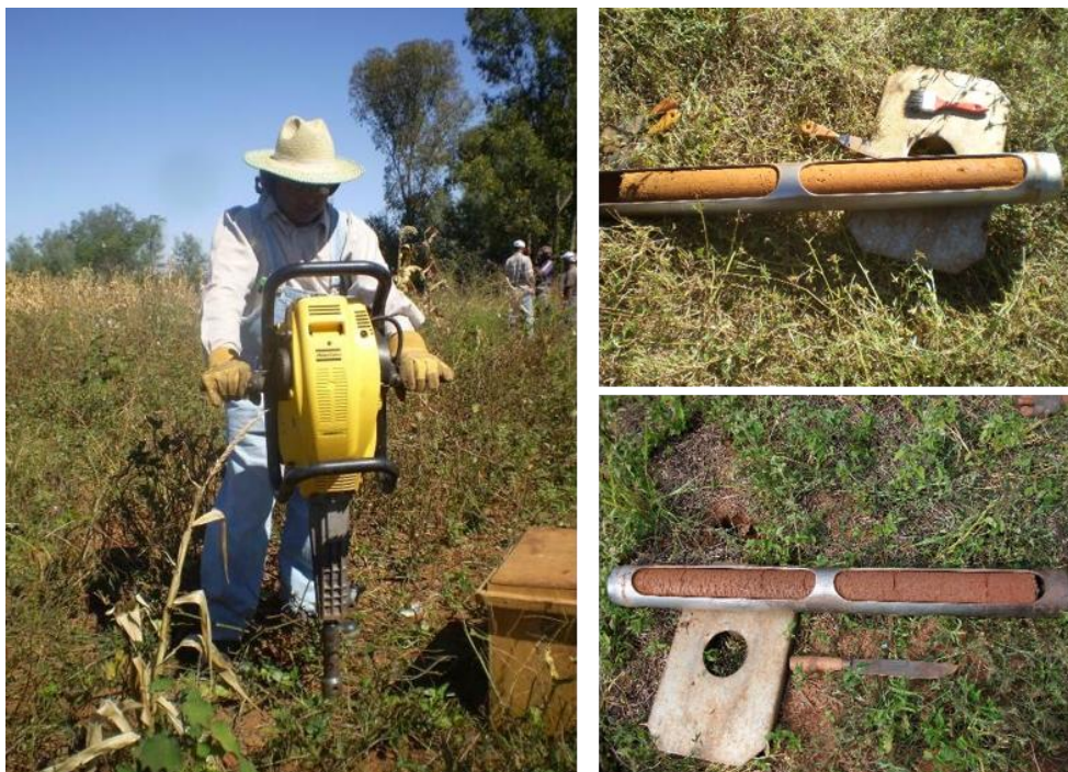
Cliché 1 : Prélèvement de sol par carottage
