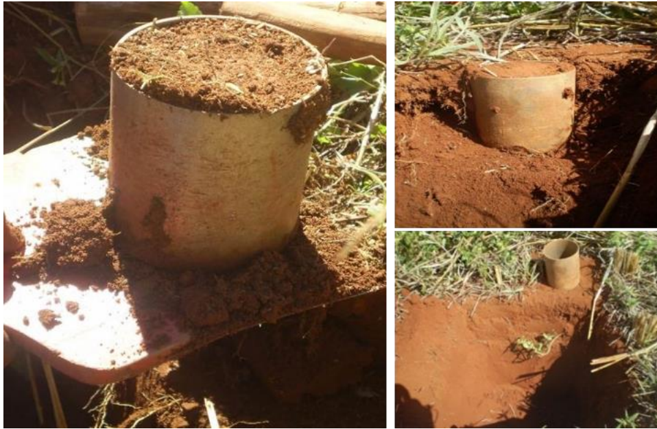
Cliché 2: Prélèvement de sol au cylindre
