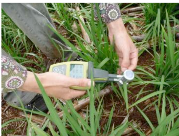
Figure 10 : Mesure au Dualex Source : Julie Dusserre (2012)
