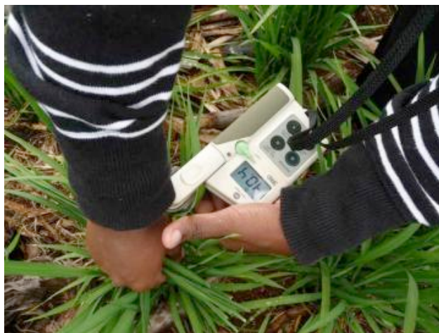
Figure 9 : Mesure au SPAD Source : Julie Dusserre (2012)
