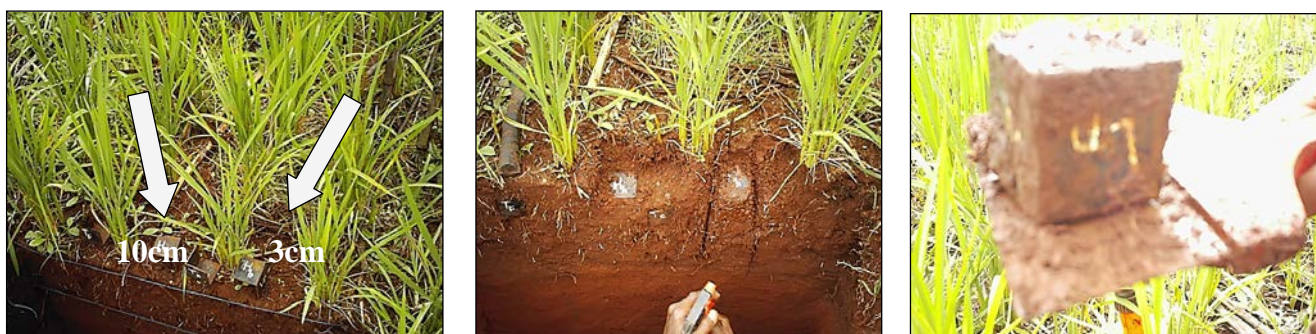
Cliche 2 : Prélèvement des cubes : photo1 position des cubes avant le prélèvement ; photo 2,3 extraction des cubes
