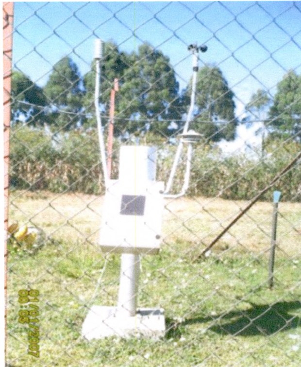
Photo 1 : Station météo automatique CIMEL du PCP- SCRID
