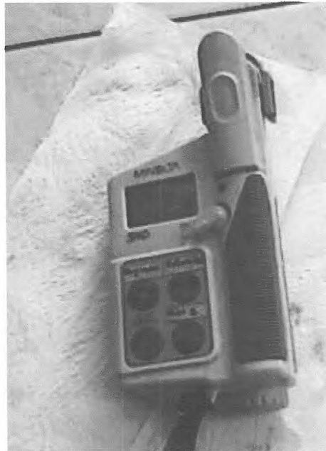
Photo n°2 : Appareil SPAD (Fenosoa, 2009)
