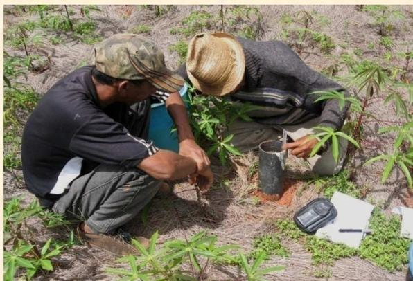
Exemple d'expérimentation : test du régime d'infiltration sur paillage
