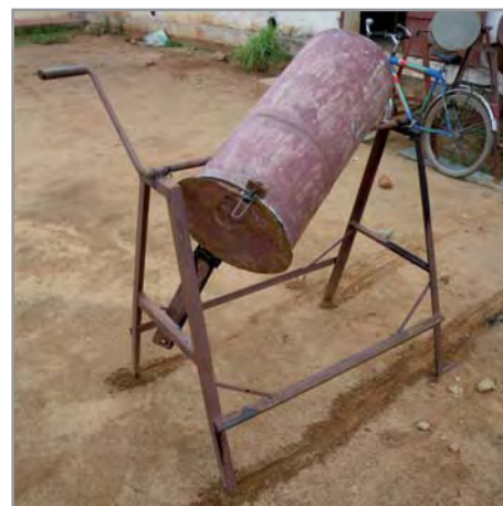
Tonneau mélangeur pour le traitement des semences Photo : F.X. Chabaud
