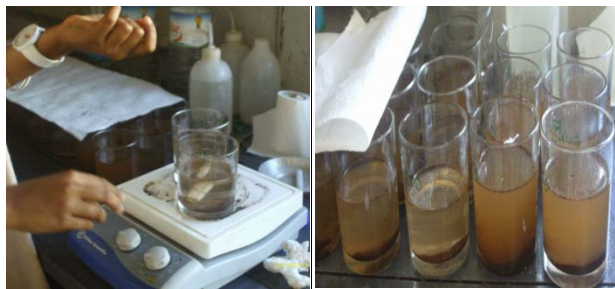
Photo 13 : Décantation et flottaison
