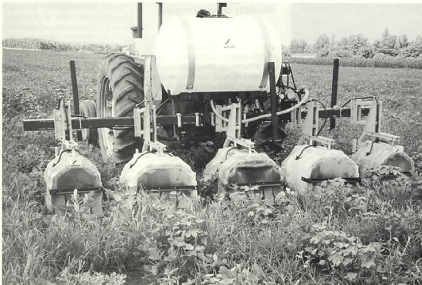
Localisateur « tunnel » d'herbicides à protection totale pour la culture.
