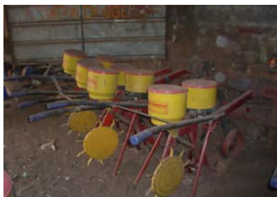
Photo 7. Importation au Mali de 6 semoirs - épandeurs de culture attelée : possibilité de localiser l'engrais et la semence.
